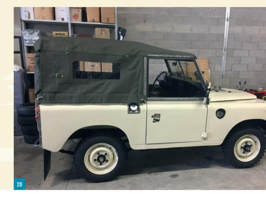
parabrezza e supporto telo sono stati sottoposti a zincatura, la mascherina anteriore ripulita, così come sono state mantenute le guarnizioni di gomma originali, ripulite e lubrificate, perché ancora in buone condizioni e già con i giusti assestamenti perciò si è preferito non montare guarnizioni nuove che, spesso, creano problemi di assestamento e un'imperfetta chiusura delle portiere. Anche le serrature sono state mantenute origi-
